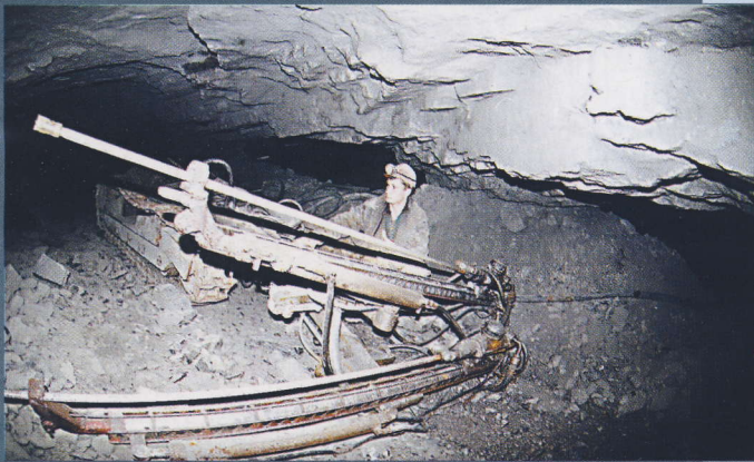
Рудник «Карнасурт»: в очистном забое, бурение установкой «Ильма»
